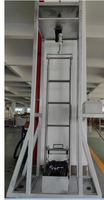
扶梯拉力测试仪 (*2022年引入并启用) Ladder Tension Test since Year 2022
